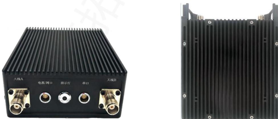
(2W/10W无人机航空机载嵌入式/图数一体MESH自组网电台)
